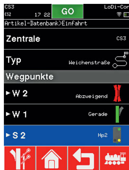
Fahrstrassen können im Handregler ganz einfach definiert und abgerufen werden.
