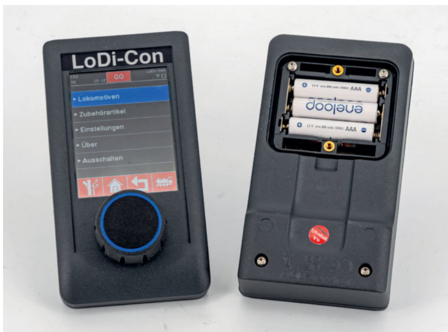
Der LoDi-Con B kann mit drei handelsüblichen AAA-Batterien oder Akkus betrieben werden.
