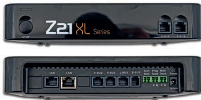
Vorder und Rückseite der Z21 mit ihren Anschlüssen: Hier lässt sich auch der MX32 Handregler von Zimo per Kabel anschließen.
