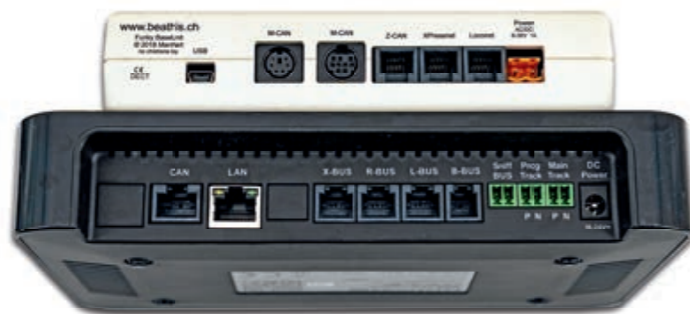
An der Z21 können mehrere Funky-Empfänger von Manhart mit bis zu jeweils vier Funkhandreglern betrieben werden.
