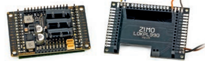
Zum Anlöten von Anschlussdrähten gibt es die zum neuen Decoder MS990 passende Adapterplatine LOKPL990.
