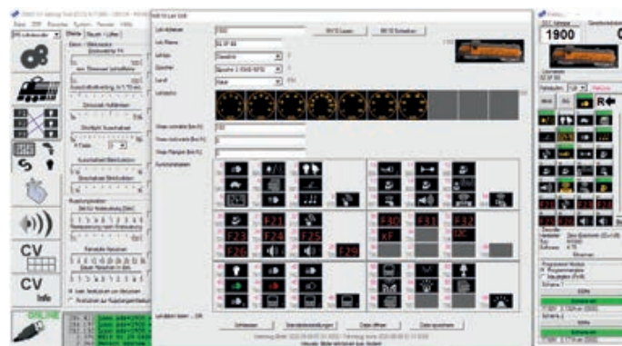
Programmieren und Testen der Zimo-Decoder mit dem Programm ZCS.
