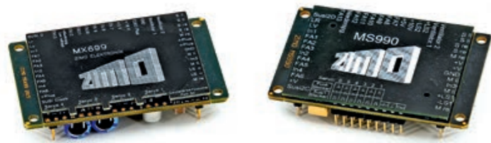
Der neue MS990 (rechts) bietet mehr Anschlussmöglichkeiten für Zubehör sowie 15 Funktionsausgänge.
