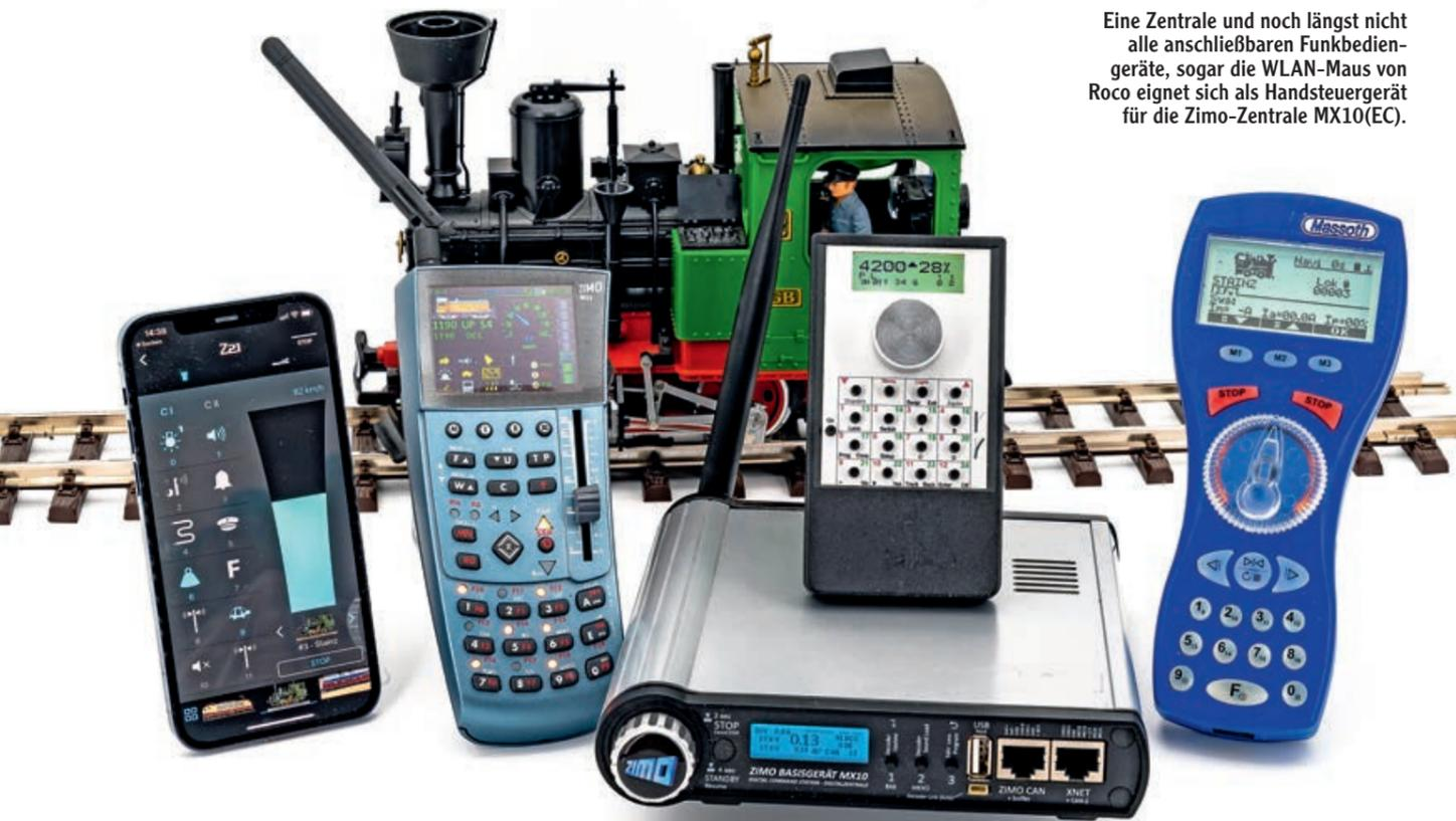
Eine Zentrale und noch längst nicht alle anschließbaren Funkbedien-geräte, sogar die WLAN-Maus von Roco eignet sich als Handsteuergerät für die Zimo-Zentrale MX10(EC).
