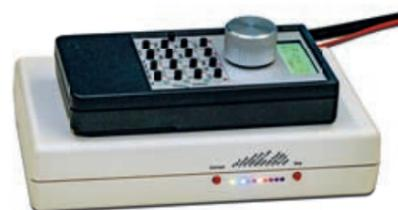
Das Funky korrespondiert über eine Basis-Station mit der Zentrale.
