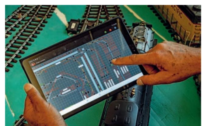
Bei der Android-Version von iTrain Remote kann man auf dem Tablet auch das Gleisbildstellwerk des iTrain-Servers aufrufen und bedienen.
