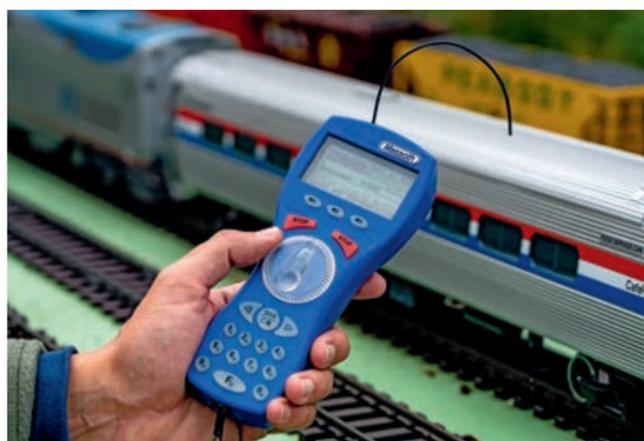
Der 433-MHz-Navigator von Massoth lässt sich an der MX10 einsetzen.
