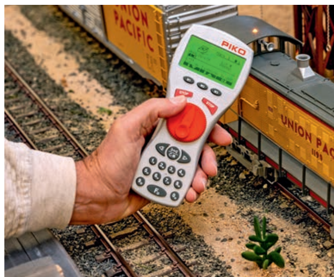
Auch der von Massoth gefertigte Piko-Navigator im 433 MHz-Band kann mit der Uhlenbrock-Zentrale über den Funk-Master kommunizieren.
