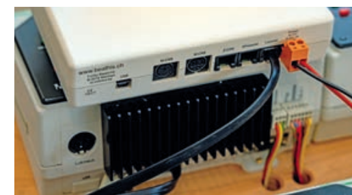
Die Funky-Basis kann an mehreren Bus-Systemen angedockt werden. Zur Stromversorgung dient eine beliebige Spannungsquelle zwischen 8 und 30 Volt.
