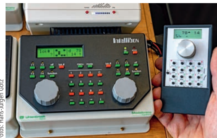
Das Funky II von Manhart kommuniziert im Dect-Standard (Haustelefon) mit seiner Basis, die ihrerseits an die Intellibox angeschlossen wird.
