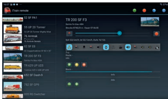
Mit einer Computer-basierten Steuerungs-Software, wie z.B. iTrain, besteht die Möglichkeit, eine Anlage über die Remote App von iTrain zu steuern. Dazu verbindet man einen Computer (Betriebssysteme Windows, macOS oder Linux) über die USB-Schnittstelle mit der Intellibox.
