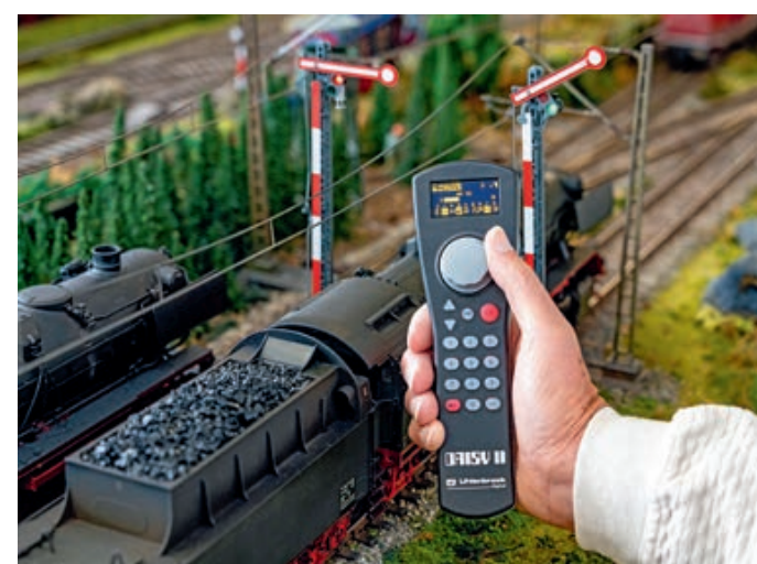
Der Funkhandregler Daisy II erlaubt eine Einhandbedienung per Daumen, das kontrastreiche Display lässt sich nicht nur innen gut ablesen.
