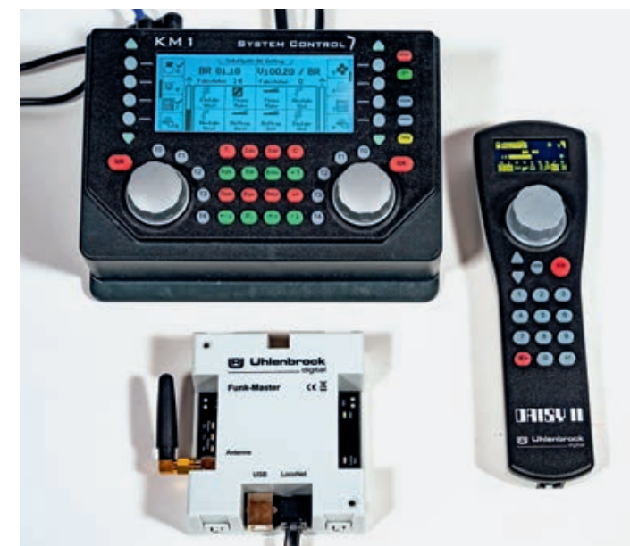
Erst der Funk-Master von Uhlenbrock macht den Daisy II Handregler unabhängig vom Kabel. Er empfängt seine Befehle und überträgt sie ins LocoNet der angeschlossenen Zentrale, ob Intellibox oder System Control 7.
