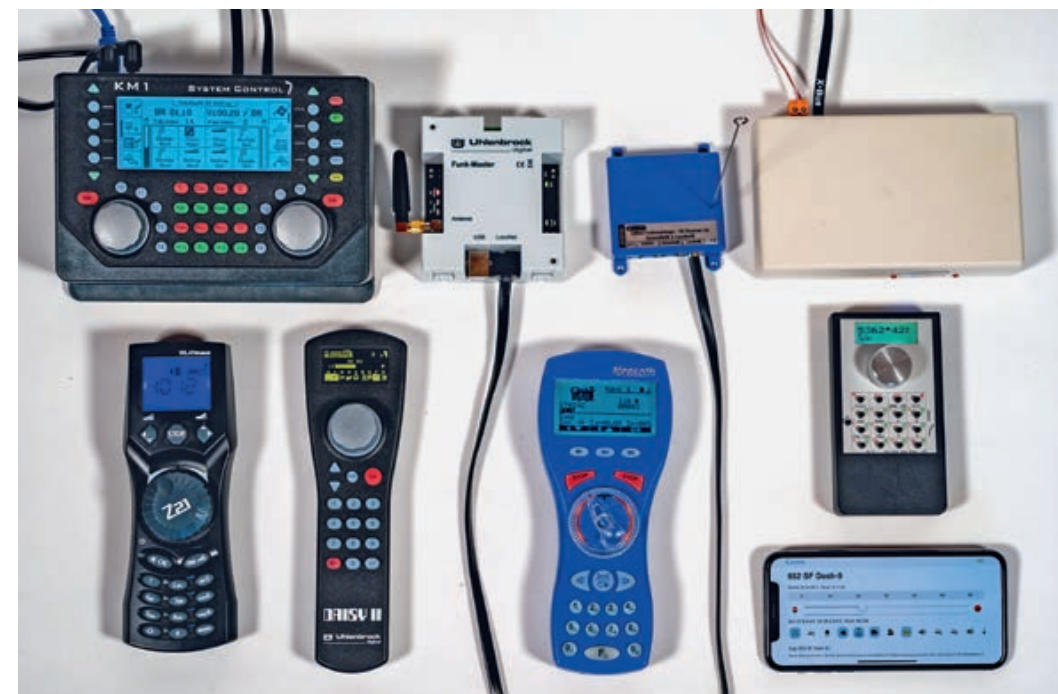
Auch der von Massoth gefertigte Piko-Navigator im 433 MHz-Band kann mit der Uhlenbrock-Zentrale über den Funk-Master kommunizieren.
