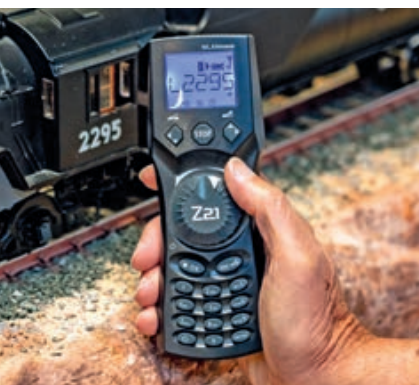
Mit dem WLAN-Adapter von MD-Electronics ist es möglich, auch die WLAN-Maus von Roco einzubinden und an der Intellibox zu nutzen.
