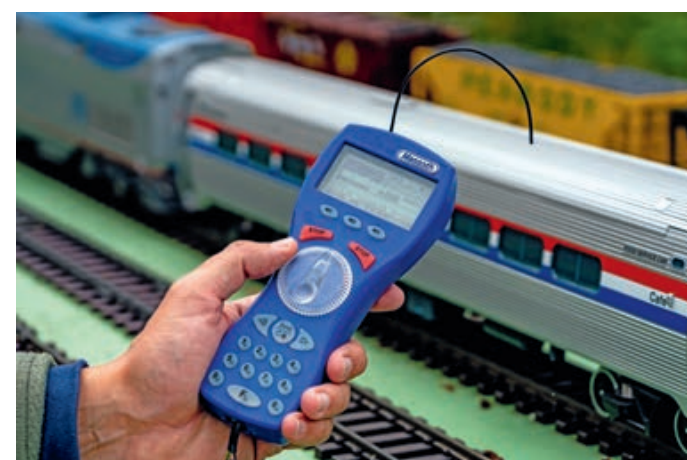
Nur der im 433-MHz-Band arbeitende Massoth-Navigator kann ins LocoNet eingebunden werden. Für den neuen Navigator in der neueren 2,4 GHz-Variante gibt es noch keinen entsprechenden Funkadapter.
