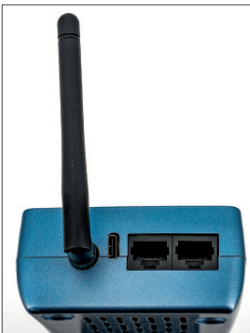
Alle Anschlüsse finden sich beim MX33FU auf der Rückseite: Antenne, USB-C und zweimal der achtpolige CAN-Bus.
